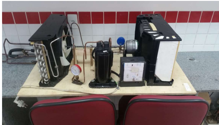
Figura 3 - Bancada de um sistema de refrigeração residencial.
